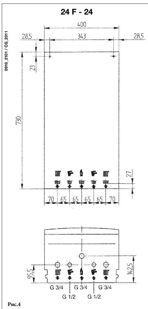
Выберите местоположение котла, затем прикрепите шаблон к стене. Подведите трубы к входным отверстиям воды и газа, размеченным в нижней части шаблона. Мы советуем установить на вход в центральную систему отопления и возврат из нее два запорных крана G3/4" (заказываются отдельно); эти краны позволяют производить сложные операции техобслуживания без слива воды из всей системы.
