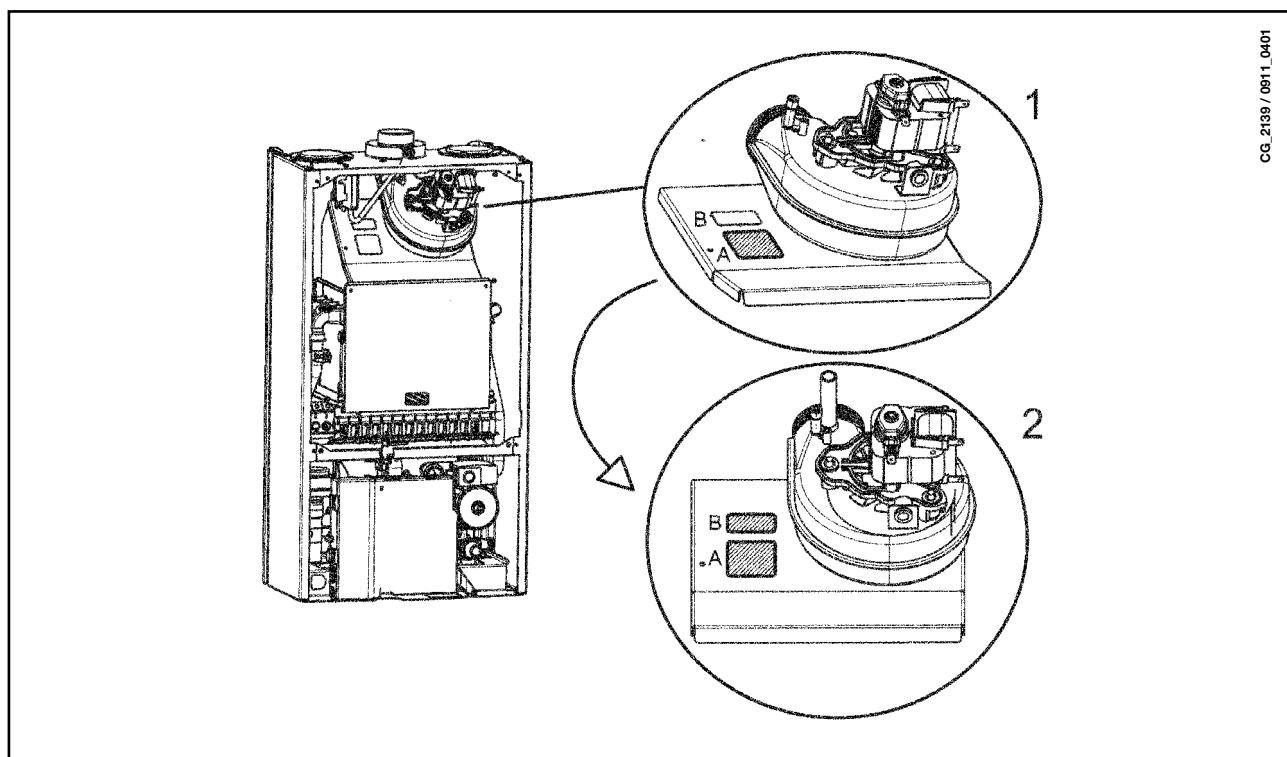
В некоторых случаях при установке дымоотводящей системы по раздельным трубам котёл может начать вибрировать. При этом возможна блокировка воздушного прессостата (код ошибки E03 на дисплее котла).
